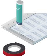
Retirar las cintas temporales de las orillas y sustituirlas con cinta aluminio en la parte alta de la instalación y cinta ventana en la parte baja del laminado. Esto con la finalidad de prevenir la entrada de polvo y suciedad, y permitir un buen drenado de la condensación. Cuando sea en arco cañón se debe colocar la cinta ventana por ambos lados.
