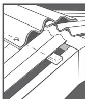
Con la lámina **Rural** podemos obtener cumbres de dos o tres ondas fijando a los apoyos de la lámina.
